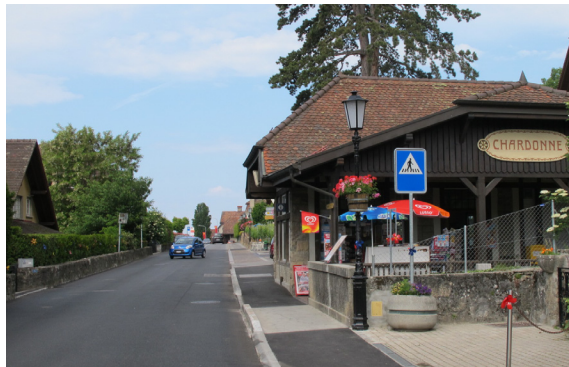
Chardonne : route de Bellevue (RC736c), mauvais exemple Liaison de la halte du funiculaire vers le village ; trottoir étroit traité de cinq manières différentes sur un petit tronçon ; pas de dispositif pour le stationnement des vélos
